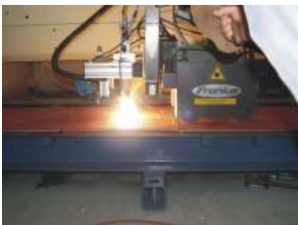
Vorführung Laser-MSG-Hybridschweißen mit einem mobilen Schweißtraktor
