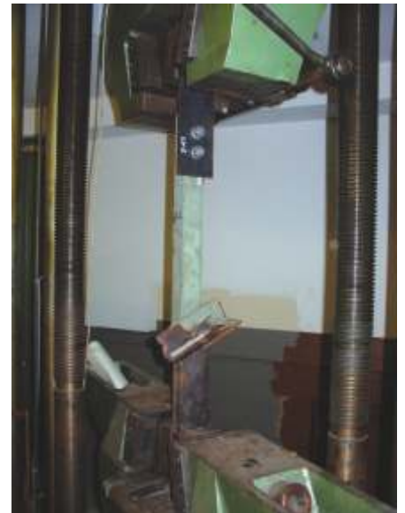
Bild 3: Prüfen eines Bauteils aus einem geschädigten Stahlmast
