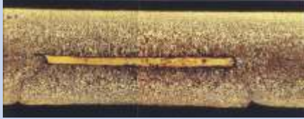
Vergleich von Punktlötung (links) und Punktschweißung (rechts)
