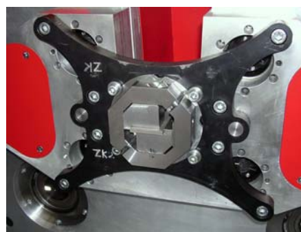
Bild 2: Bauteilaufnahme für Flachbandverbindungen 40x5 mm
