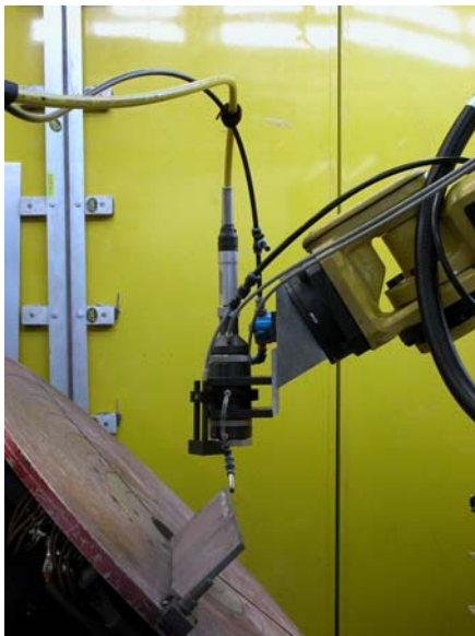
Bild 1 und 2: Versuche zur Kantenbearbeitung mit dem Diodenlaser
