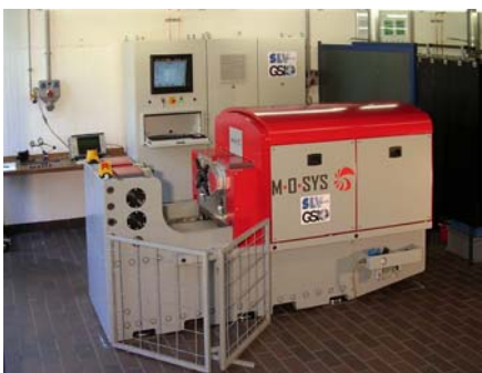
Bild 1: 10-t-Multi-Orbital-Reibschweißmaschine, Typ "MOSYS100"
