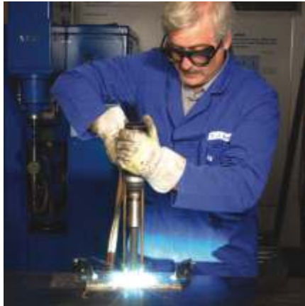
Bolzenschweißen in der SLV Duisburg
