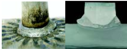
Ansicht und Einbrandform einer optimalen W-S-Bolzenschweißung
