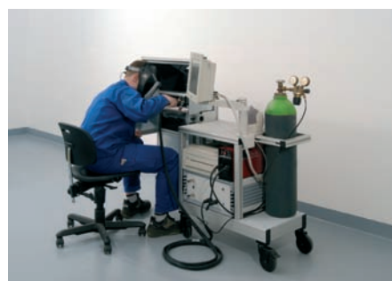
In der SLV Halle GmbH entwickelter Schweißtrainer
