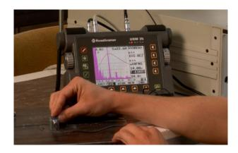
Weiterhin werden die Fertigkeiten zur Prüfung einfacher Bauteile aus Stahl und anderen Werkstoffen erworben. Nach Prüfanweisungen werden Wanddickenmessungen, Blechprüfungen, Ortungen von Unregelmäßigkeiten durchgeführt und nach Vorgaben von Regelwerken protokolliert.
