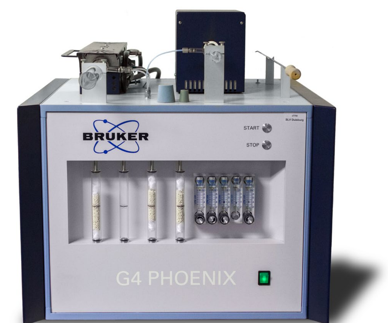
Messung des diffusiblen Wasserstoffs
