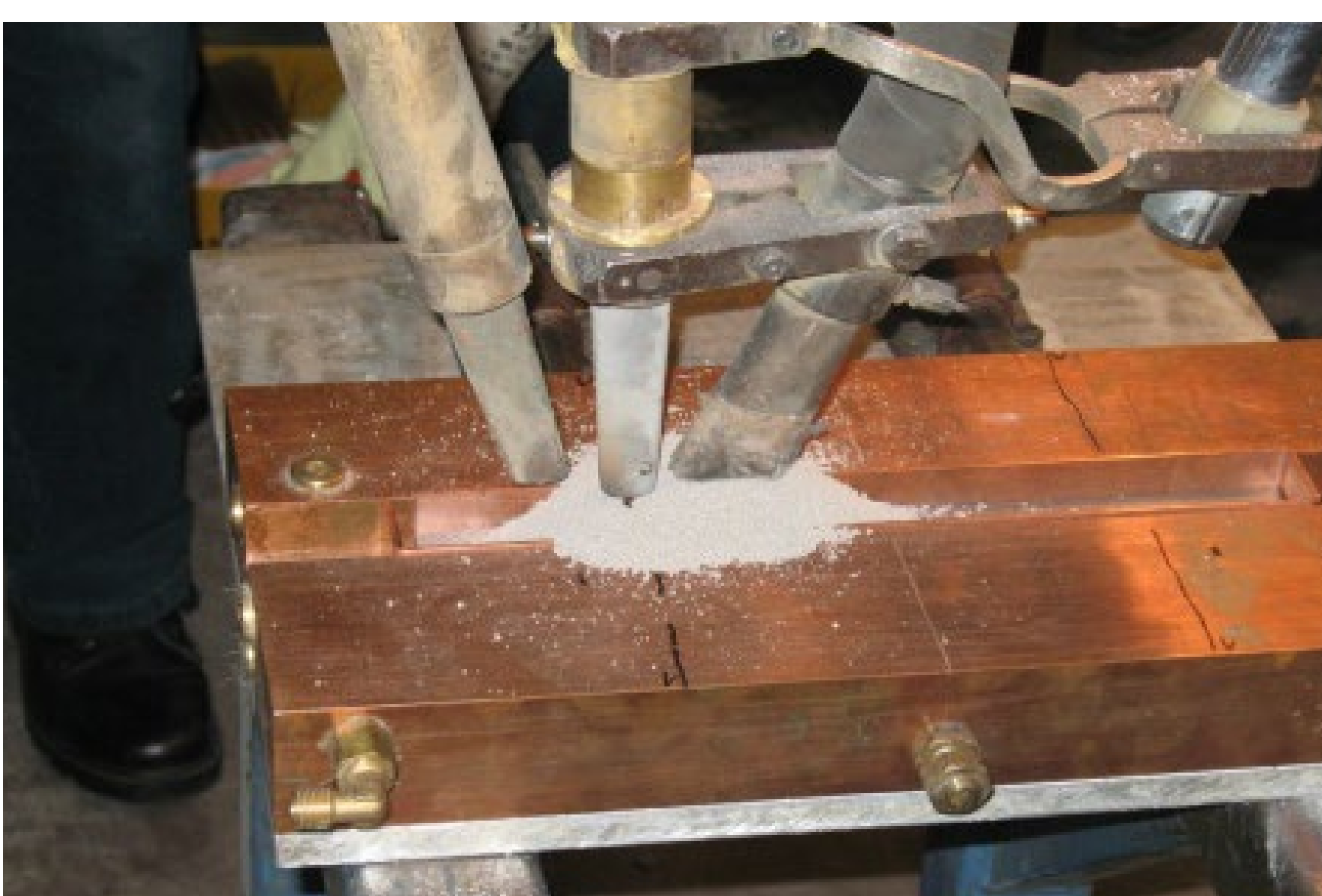
Schweißversuch nach DIN EN ISO 3690 in der Werkstatt
