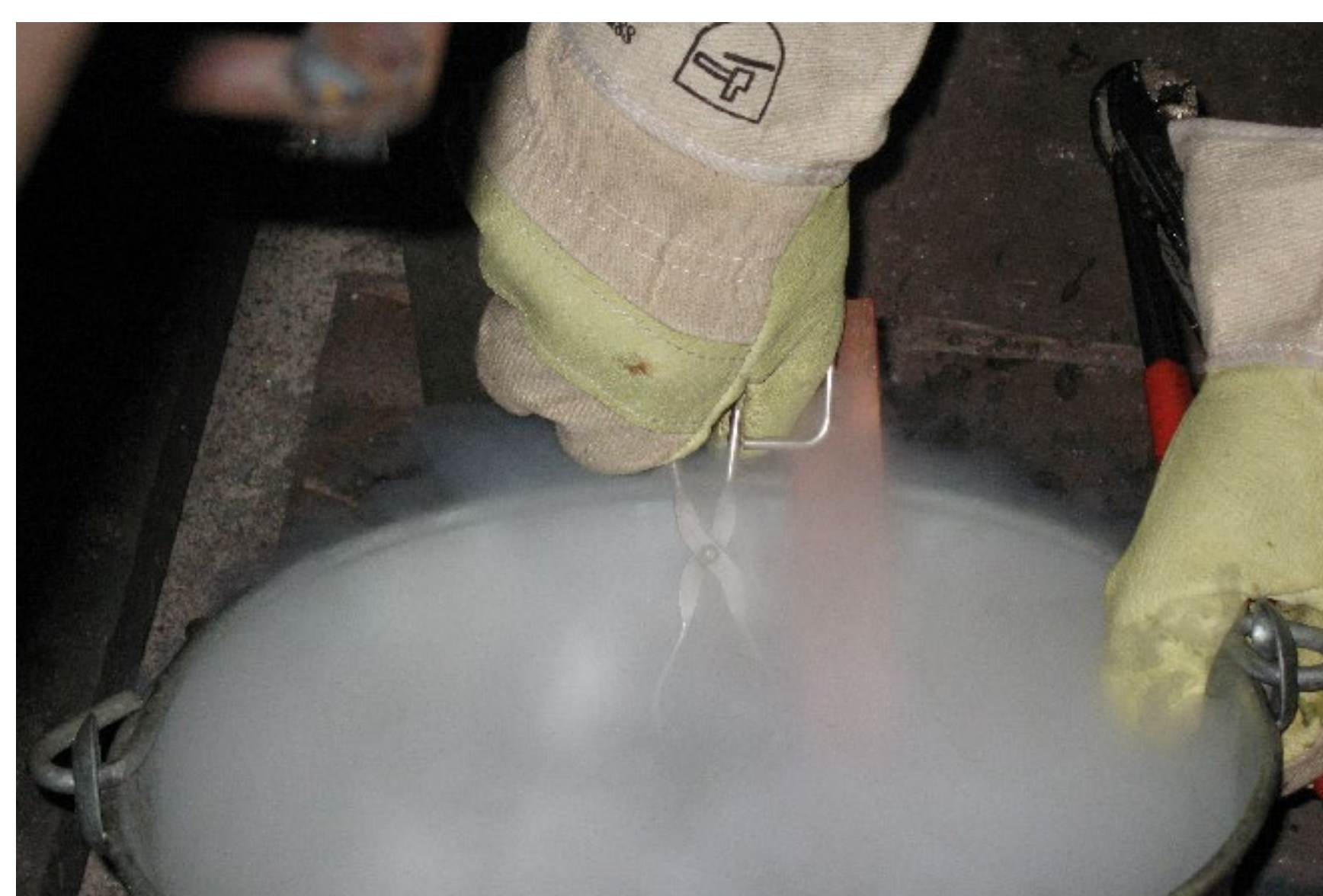
Abkühlen der geschweißten Proben in flüssigem Stickstoff
