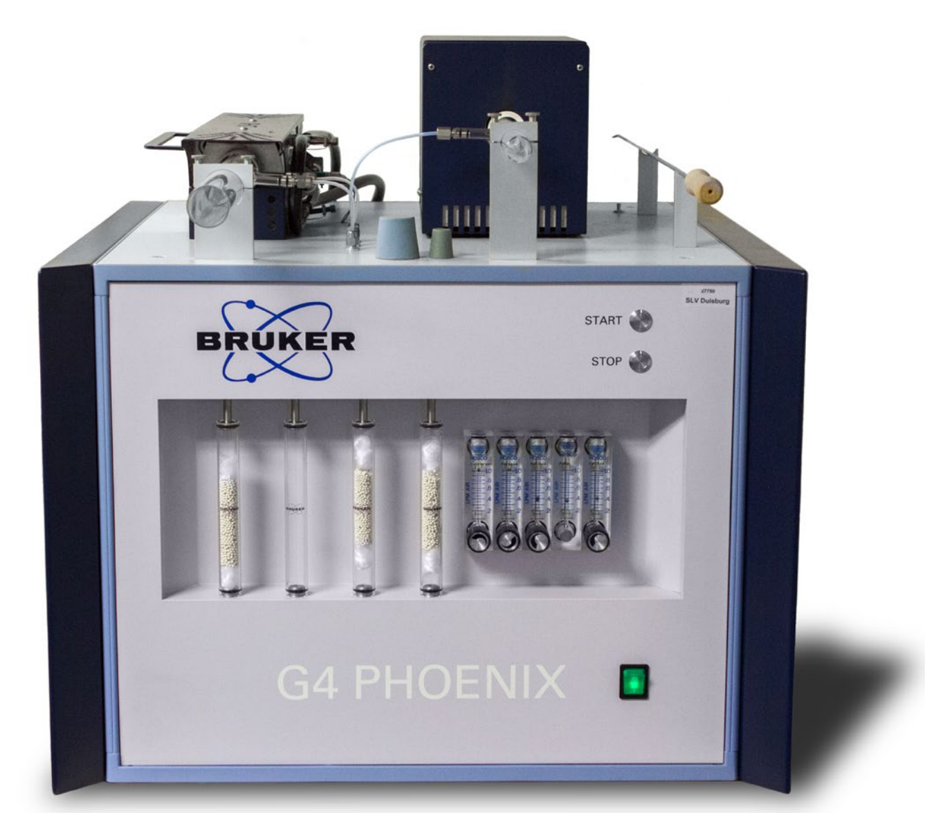
Messung des diffusiblen Wasserstoffs in der Schweißprobe
