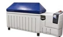
Für die Exposition von Materialien in verschiedenen Klimaten steht der SLV Duisburg eine moderne **Klimakammer im Korrosionslabor** zur Verfügung. Sie erlaubt eine, auf die Kundenanforderungen abgestimmte, Korrosionsbelastung im Temperaturbereich zwischen 25°C und 60°C einzustellen. Neben den kundenspezifischen Testbedingungen können natürlich auch genormte Klimatests, wie z.B. nach VDA 621-415, DIN EN ISO 6270-2 und DIN EN ISO 9227 durchgeführt werden.
